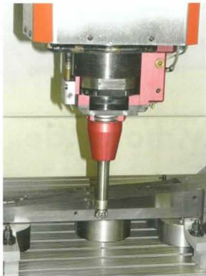
Bild 5: Selbst bei weniger anspruchsvollen Bauteilen sind damit mit dem Medium-Verteiler eine höhere Prozesssicherheit und Standzeitverlängerung der Werkzeuge zu erzielen
