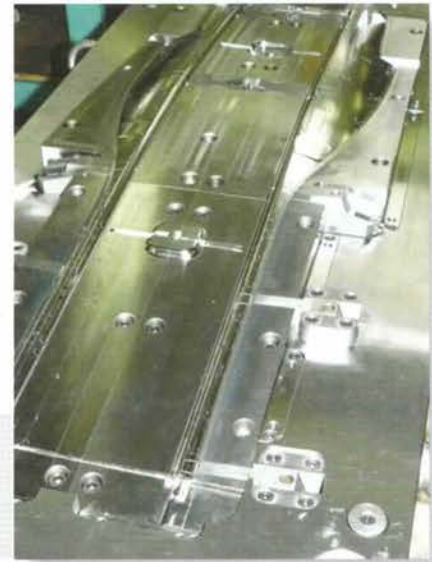
Bild 6: Die Werkzeuggrößen konnten bei Bähr durch den Medium-Verteiler von 1,5 auf 4,5 Tonnen erhöht werden
