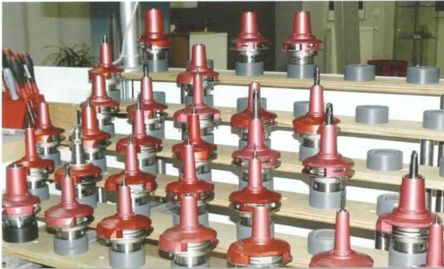
Bild 1: Den Medium-Verteiler gibt es in den Größen HSK 25, HSH 32, HSK 40, HSK 50 und HSK 63, für Werkzeuge von 0,2 mm bis 38 er Messerkopf. Auf Wunsch sind aber auch andere Größen lieferbar
