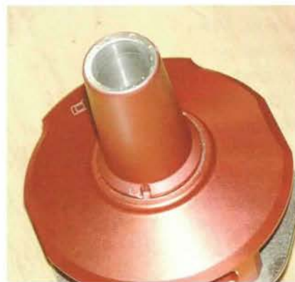
Bild 3: Die Bohrungen sind in unterschiedlichen Winkeln im Düsenkörper eingebracht, so strömt die Luft/Medium ringförmig direkt an die Schneide
