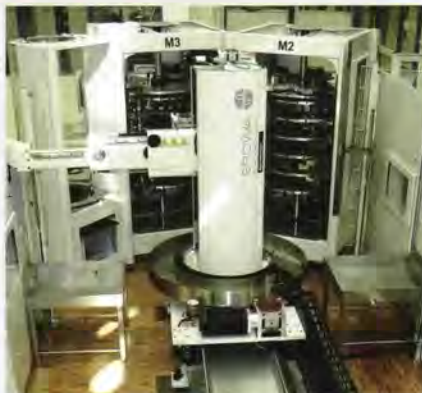
Die Liniensautomation umfasst drei Senkerodiermaschinen Gantry Eagle 400, wobei eine der Maschinen auch als Stand-Alone-Einheit genutzt wird.
