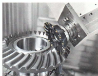
In Zusammenarbeit mit Sandvik Coromant wurden für das Heller-Verzahnungsfräsen angepasste Topffräser mit entsprechenden Schneidplatten entwickelt.
