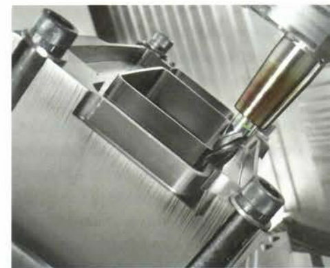
4 Simultanes 5-achsiges Fräsen gebogener raumschräg orientierter schlanker Strukturelemente aus dem Vollen
