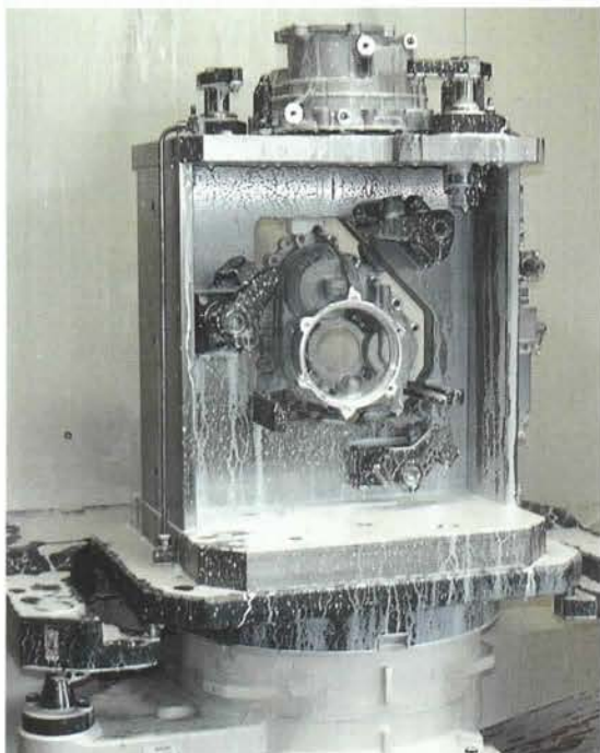
Präzise Dauerläufer: Bei dem Gehäuse für das 8-Ganggetriebe liegen die Toleranzen innerhalb von wenigen Hundertstel mm; aufgrund der hohen Präzision der H 4000, aber auch durch die Erfahrung der Mitarbeiter ist das bei Kreidler kein Problem. Bilder: Heller
