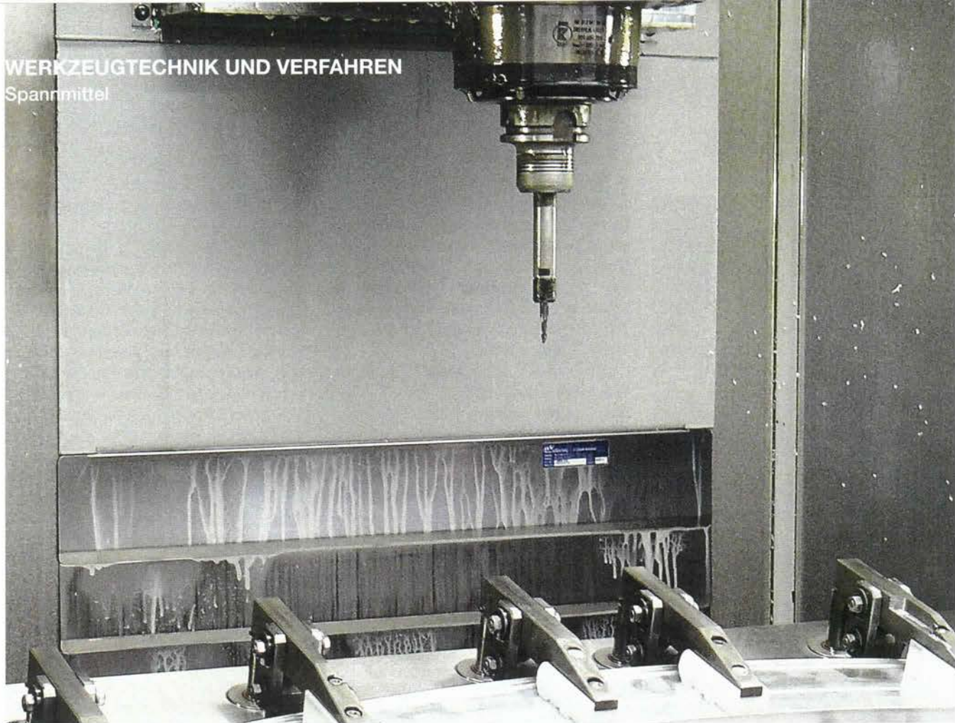
Komplettbearbeitung: Das Bauteil wird auf einem 5-Achs-Bearbeitungszentrum mit sehr aufwändiger Vorrichtung gefertigt. Bilder: Fahrion
